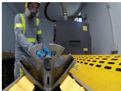
Fig. 3. MATSA: preparación de testigos de sondeos.
